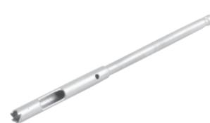
**515058** Tournevis Hex.2,5 dynamométrique 1,5Nm maxi avec douille pincette.
